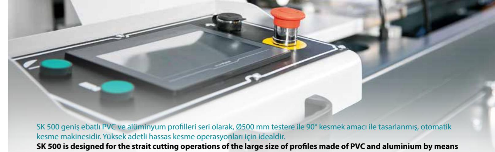
SK 500 geniş ebatlı PVC ve alüminyum profilleri seri olarak, Ø500 mm testere ile 90° kesmek amacıyla tasarlanmış, otomatik kesme makinesidir. Yüksek adetli hassas kesme operasyonları için idealdir.
